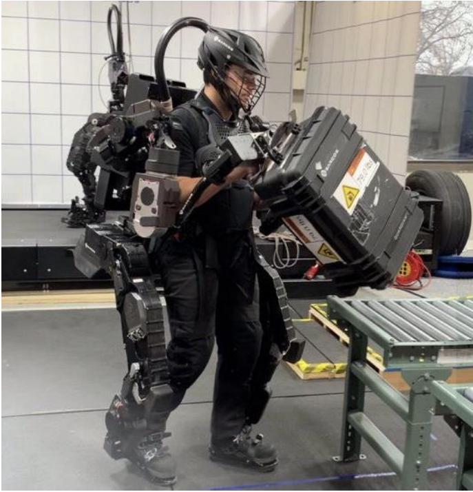
«اکسو اسکلتون» اسکلت بیرونی، انسان-روبات، کارگر نیمه‌مکانیکی!!
